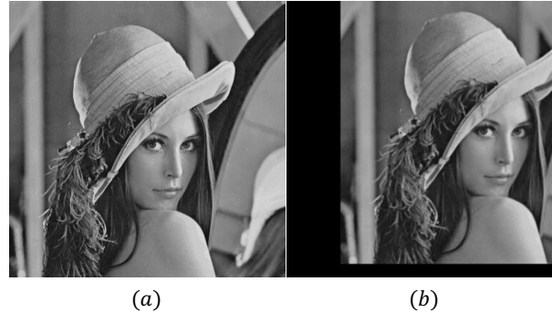
Figura 2.5. Traslación de una imagen digital 100 píxeles sobre el eje x y 50 píxeles sobre el eje y (Gonzalez et al., 1996).
